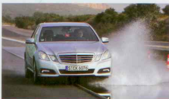
Při testu akvaplaningu se sleduje rozdíl mezi otáčkami kol na přední a zadní nápravě.
